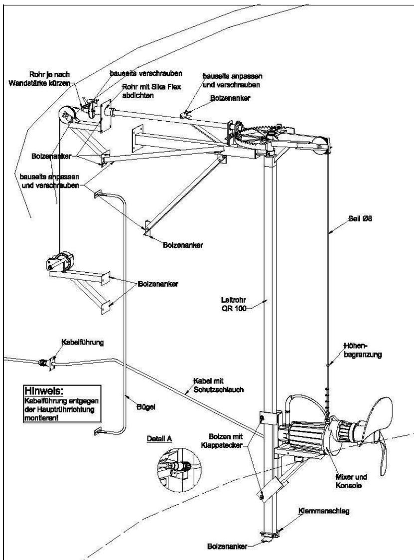
Tauchmotorrührwerke bieten in Biogasanlagen viele Vorteile: geräuscharmer Lauf, guter Wirkungsgrad, besonders gute Verstellmöglichkeiten bei wechselndem Füllstand z.B. im Gärrestlager
